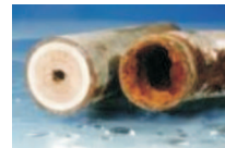
Beispiel für Korrosion in Heizungsleitungen
